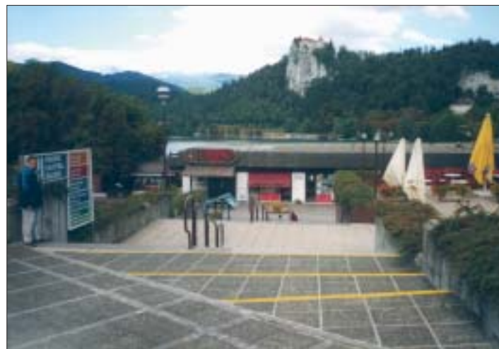
Foto n. 56 - Lago di Bled, Slovenia, le scale sono contrassegnate con una fascia gialla e il corrimano è posto al centro della scala
