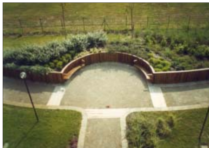
Foto n. 1 - Reggio Emilia, Centro diurno per disabili Tagliavini-Ferrari: area di sosta con panchine poste a cerchio, dotate di appoggio per rialzarsi più facilmente. Dietro si notino le aiuole rialzate per coltivazioni accessibili.
