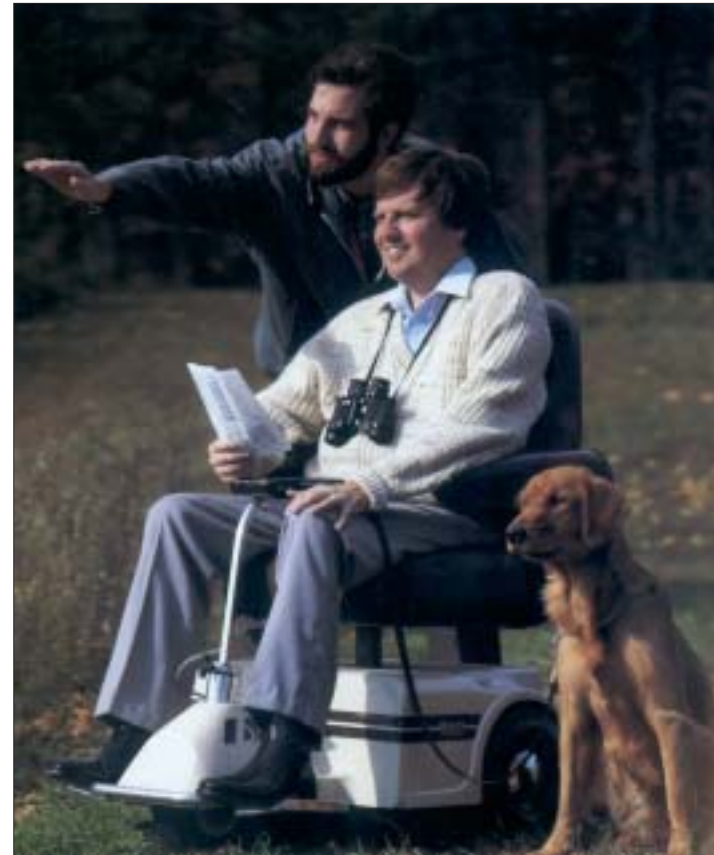
Foto n. 85 - Scooter elettrico a tre ruote di piccole dimensioni, azionabile tramite due leve; adatto al noleggio in grandi parchi urbani o naturali; buono per fondi asfaltati o comunque ben compattati.
