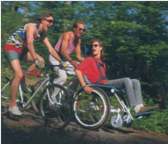
Foto n. 78 - Bicicletta dotata di sistema di aggancio di carrozzina manuale, adatta a fondi asfaltati o compattati molto bene.
