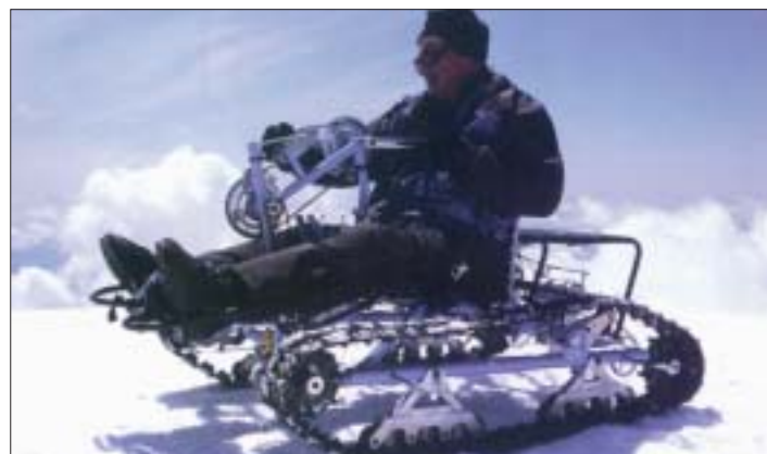
Foto n. 83 - Ciclo speciale di produzione artigianale per procedere su percorsi ghiacciati, anche con forti pendenze; la trasmissione del movimento è manuale, simile a quella dei "ciclioni" utilizzati in periodo estivo.
